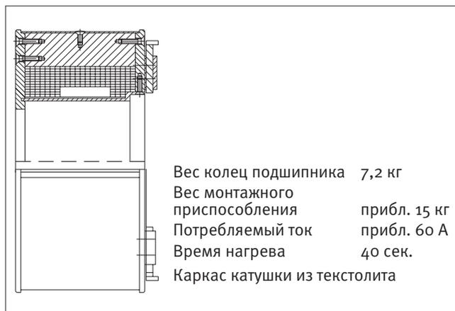
87. Схема индукционного нагревателя для сети напряжением 400 В с pedalным выключателем для внутренних колец цилиндрических роликоподшипников диаметром отверстия 130 мм.
