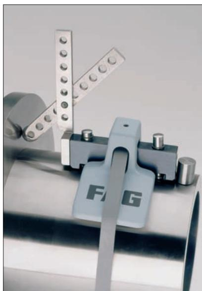
63б. Конусность цапфы измеряется прибором для контроля конусности FAG MGK9205
