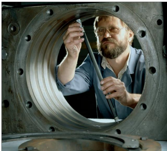
66. Отверстие крупногабаритной подушки измеряется внутренним микрометром
